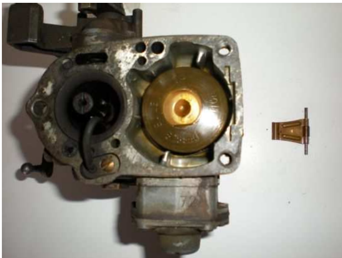
Dégager le basculeur (3) et le flotteur.
