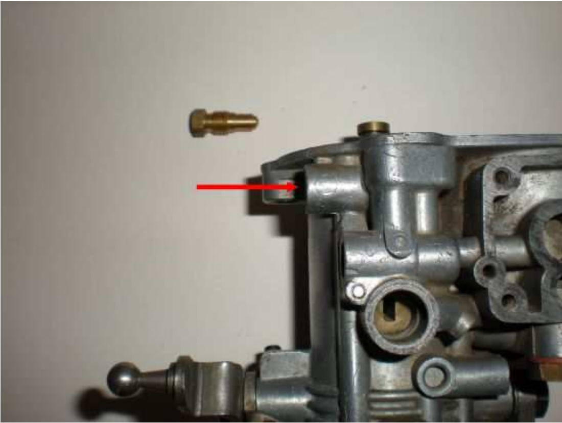
visser le gicleur (16) de pompe, intercaler un joint fibre.
