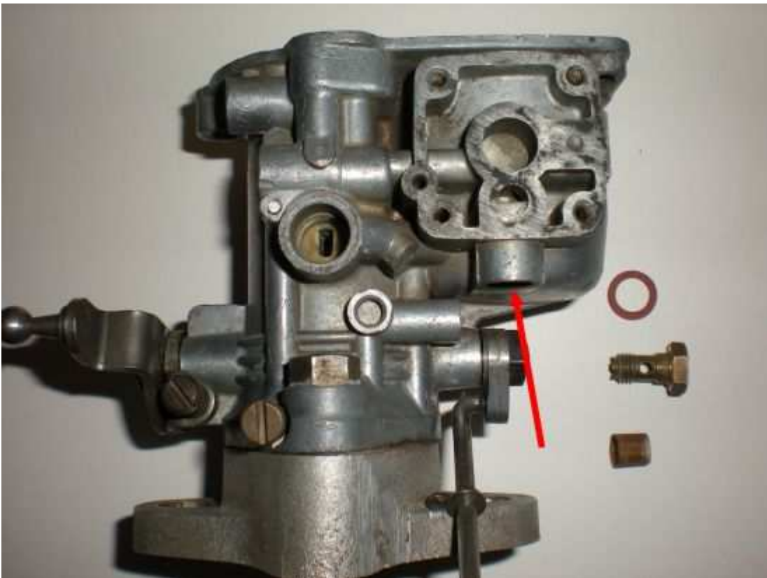
Monter le clapet de pompe (21) muni de son filtre, intercaler un joint fibre.
