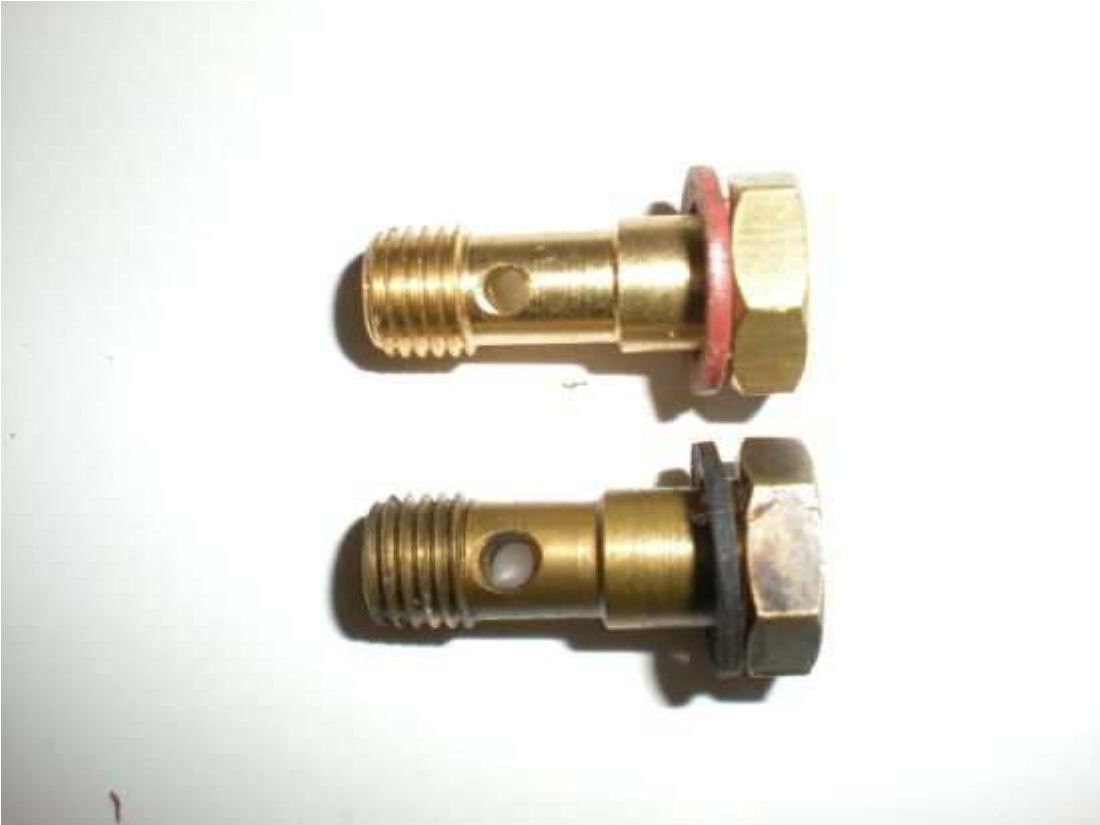
visser le gicleur (16) de pompe, intercaler un joint fibre.
