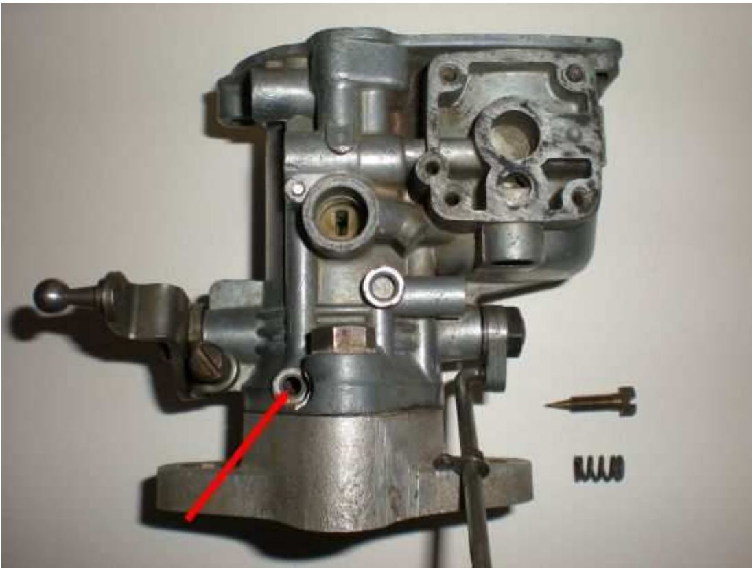
Monter le clapet de pompe (21) muni de son filtre, intercaler un joint fibre.
