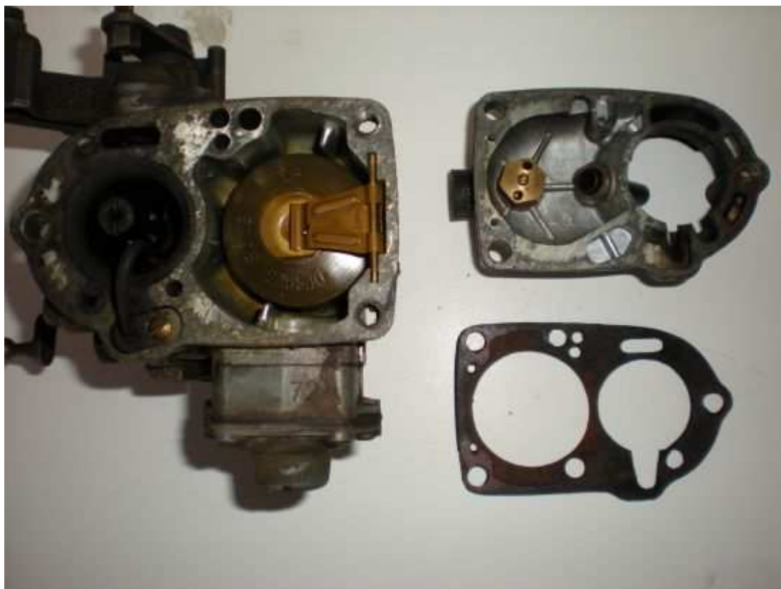
Dégager le joint papier (2)
