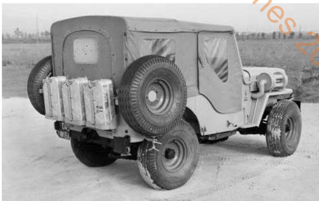
Le 8 novembre 1957, l'ERM d'Alger organise une exposition de plusieurs véhicules dont cette JH101 "saharienne" du CREPS (Compagnie de recherches et d'exploitation de pétrole au Sahara) qui préfigure le lancement des études de la M201 Sahara. Notez les pneus sable avec 2 roues de réserve à gauche et à droite, les 3 jerrycans arrière, le filtre à air, le phare de recherche sur le parebrise et les lames de ressort de rechange devant la calandre.
