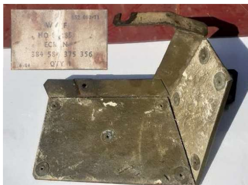
« La référence 81285, « Ecran de protection de la pompe à essence mécanique », commune aux 6V et 24V, n'est pas présente dans l'annexe du MAT3152. » Collection JLM201
