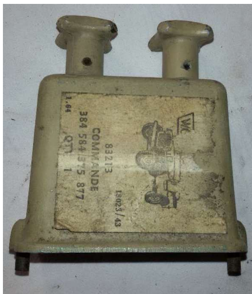
« La référence 83213 « Commande des robinets d'essence assemblée », communes aux 6V et 24V ne figure pas dans la liste des pièces spécifiques. L'intitulé de l'annexe au MAT3152 ci-dessous est simplement « Boîtier assemblé de commande des robinets d'essence », sans référence. » Photo Jacky VINCENT
