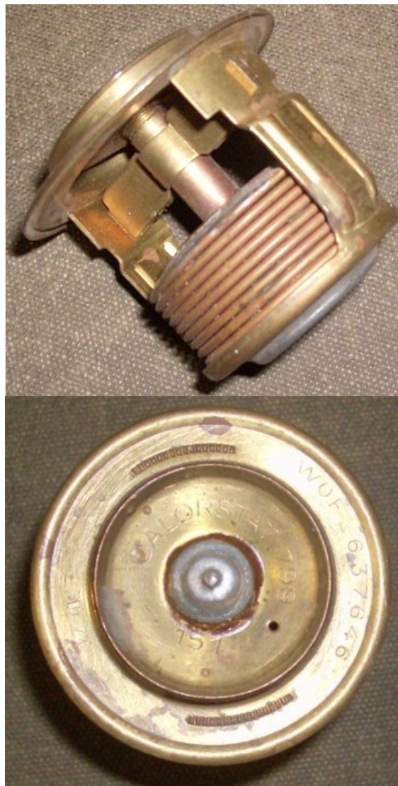
Thermostat d'origine M201 (WOF 637646), marqué 151 (°F) (77° C)
