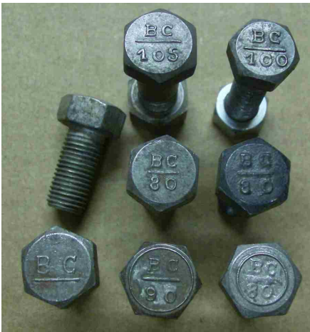
Vis BC, BC80, BC100, BC105 avec 1 trait : UNF
